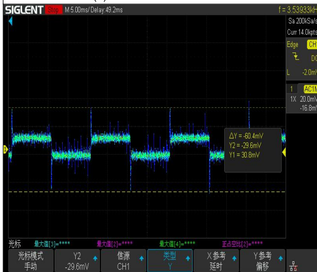
图(5) 25%~50%负载动态波形
